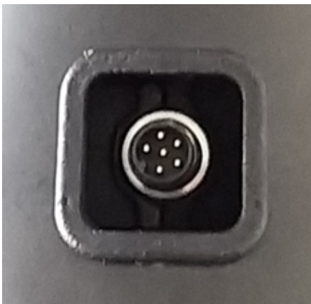
Abbildung 35: 6-polige DIO-Buchse am Roboterarm
