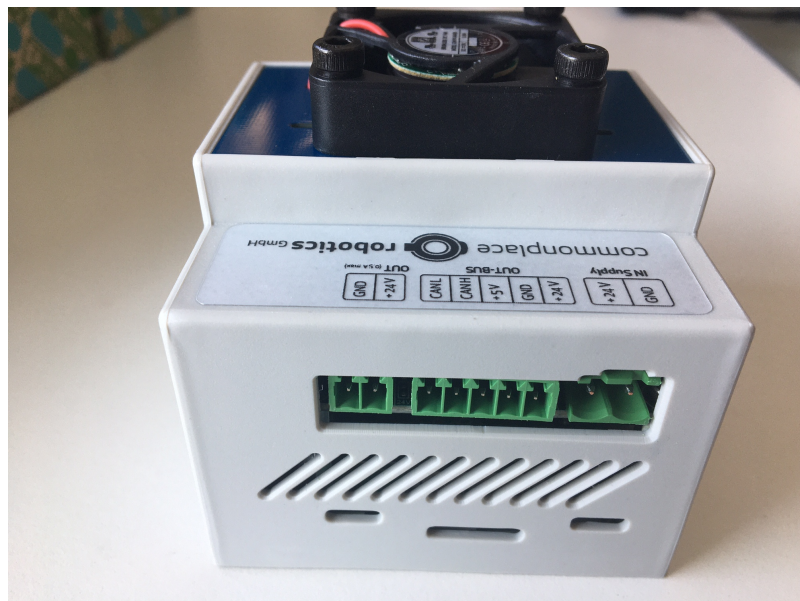
Abbildung 10: Bus- und Stromversorgungsanschluss. Der "+24V Out" Steckverbinder bleibt ungenutzt.
