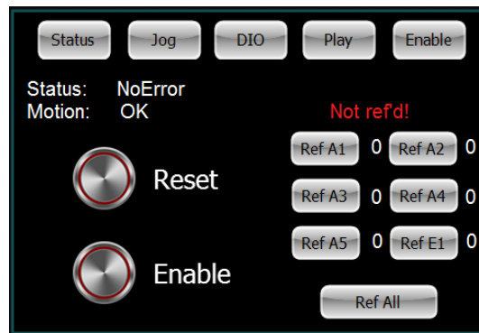
Abbildung 25: Drücken Sie "Enable": Der Status wechselt zu "NoError". "Not ref'd!" (in rot) bedeutet "nicht referenziert".
