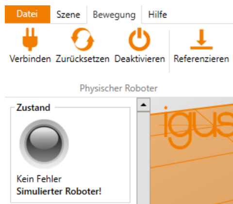
Abbildung 16: Schaltflächen für die Verbindung mit der Hardware, das Zurücksetzen von Fehlern und die Aktivierung der Motoren, die Referenzierung und "Status"-Anzeige.
