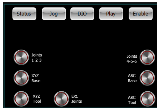
Abbildung 26: 1. Drücken Sie dazu die Taste "Jog" oben auf dem Display. 2. Drücken Sie "Joints 1-2-3". Dann bewegen und drehen Sie den Joystick. Sie können nun die Achsen 1, 2 und 3 bewegen. 3. Drücken Sie "Joints 4-5-6". Bewegen Sie nun die Achsen 4 und 5 durch Bewegen und Drehen des Joysticks.
